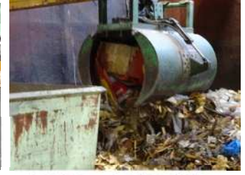
火元をクレーンで掴み容器へ燃え広がらないよう二次災害対策
